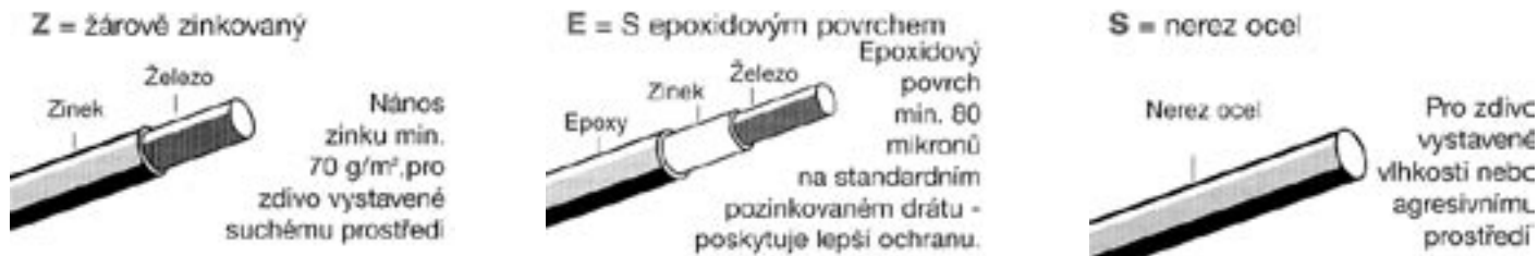
Obr. 9-11 Typy povrchové úpravy výztužných prvků MURFOR®
